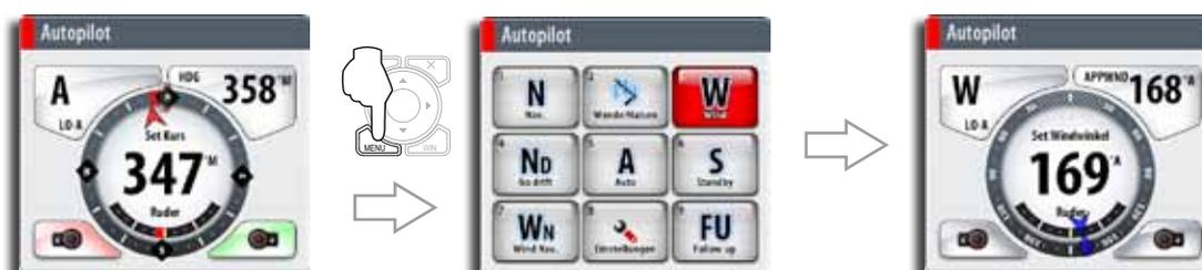
Der eingestellte zu steuernde Kurs und der eingestellte Windwinkel werden vom Kompasskurs und dem Windmessgerät in dem Moment erfasst, in dem der WIND-Modus ausgewählt wird. An diesem Punkt ändert der Autopilot den Kurs, um den Windwinkel beizubehalten, wobei die Windrichtung sich ändern kann.
