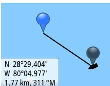
También puede iniciar la función de medición sin un cursor activo. Ambos iconos de medición se colocarán inicialmente en la posición de la embarcación. El icono gris seguirá a la embarcación a medida que se mueva, mientras que el icono azul permanecerá en la posición proporcionada al activar la función.
