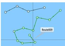
La versión de software 2.0 de NSO evo2 incluye compatibilidad con Autorouting de Navionics e Easy Routing de Jeppesen. Esta función sugiere de forma automática puntos de ruta entre el primer punto de ruta y el último de una ruta, o entre los puntos de ruta seleccionados en una ruta compleja. Puede utilizar la función cuando cree una nueva ruta o para editar rutas que ya están guardadas.
