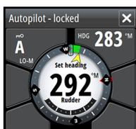
El sistema AP24/AP28 incluye una función de bloqueo remoto que desactiva el control del piloto automático de las demás unidades de control. Una unidad de control bloqueada se indica con un símbolo de llave en el cuadro emergente del piloto automático.
