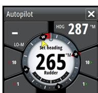
Si la unidad NSO evo2 se ha conectado a un sistema EVC a través de un ordenador SG05, puede tomar control manual del gobierno independientemente del modo del piloto automático.
