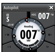
Si la unidad NSO evo2 está conectada a un sistema de piloto automático que incluye una unidad de control AP24 o AP28, solo puede haber una unidad de control activa a la vez. Una unidad de control inactiva se indica mediante un cuadrado con una cruz en el cuadro emergente del controlador del piloto automático.
