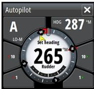
El controlador del piloto automático, que indica información sobre el modo activo, el rumbo, el timón y otros datos de gobierno en función del modo de piloto automático activo.
