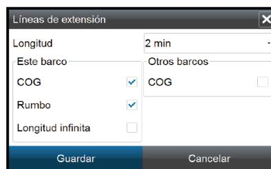
La información de rumbo de la embarcación se obtiene del sensor de rumbo activo, y la información COG, del sensor GPS activo.
