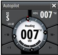
In caso di connessione di NSO evo2 a un sistema di pilota automatico che include un'unità di controllo AP24 o AP28, solo un'unità di controllo può essere attiva contemporaneamente. Un'unità di controllo inattiva è indicata da un quadrato con un simbolo a forma di croce nel popup del controller del pilota automatico.
