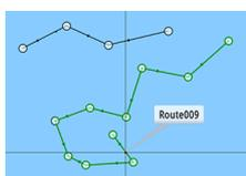
La NSO evo2 versione software 2.0 include il supporto per Navionics Autorouting e Jeppesen Easy Routing. Questa funzione suggerisce automaticamente i punti della rotta tra il primo e l'ultimo punto oppure tra i punti selezionati in una rotta complessa. È possibile utilizzare la funzione quando si crea una nuova rotta oppure per modificare rotte già salvate.
