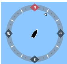
È possibile scegliere di visualizzare il simbolo di una bussola intorno alla propria imbarcazione sul riquadro cartografico. Il simbolo della bussola scompare quando il cursore è attivo nel riquadro.
