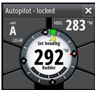
L'unità di controllo AP24/AP28 comprende una funzionalità di blocco remoto in grado di disattivare il controllo del pilota automatico da tutte le altre unità. Un'unità di controllo bloccata è indicata da un simbolo a forma di chiave nel popup del controller del pilota automatico.
