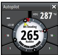
Se NSO evo2 è collegato a un sistema EVC tramite SG05, è possibile assumere il controllo manuale del timone anche se è attiva la modalità Pilota automatico.
