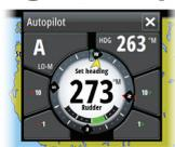
Régler, le cap compas (Mode Auto), l'angle du vent (Mode Wind) et paramétrer une route (Mode NoDrift) en cliquant sur les boutons **Babord** et **Tribord** dans la fenêtre pilote automatique.
