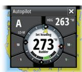
Ajuste del rumbo establecido (modo automático), ángulo de viento (modo de viento) y el curso fijado (Modo Sin Deriva):
