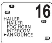
1. Halten Sie [AIS/IC] gedrückt, bis das HAILER-Menü angezeigt wird.
