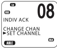
Die Funkanlage sendet das Bestätigungssignal und wechselt zum angegebenen Kanal.
