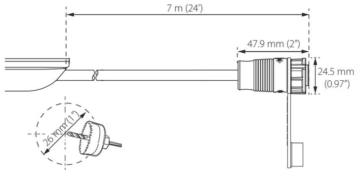
Damit das Kabel ausreichend Platz hat, wird eine Bohrung mit einem Durchmesser von 26 mm empfohlen.
